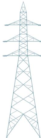
Ligne aérienne de 380 kV: on mesure une valeur de 100 µT jusqu'à une distance de 4 mètres environ des conducteurs, mais aucune personne ne devrait séjourner dans cette zone. A une distance de 60 mètres environ, le champ magnétique est < 1 µT.
